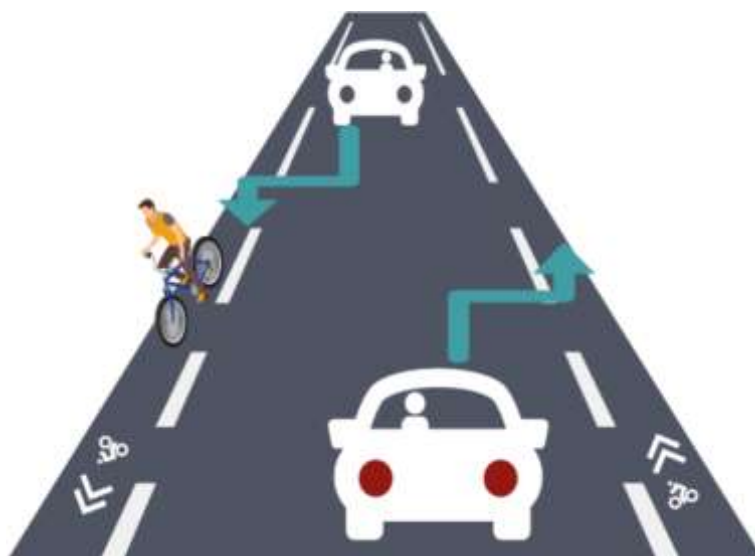
Principe d'une chaussée centrale à voie banalisée
