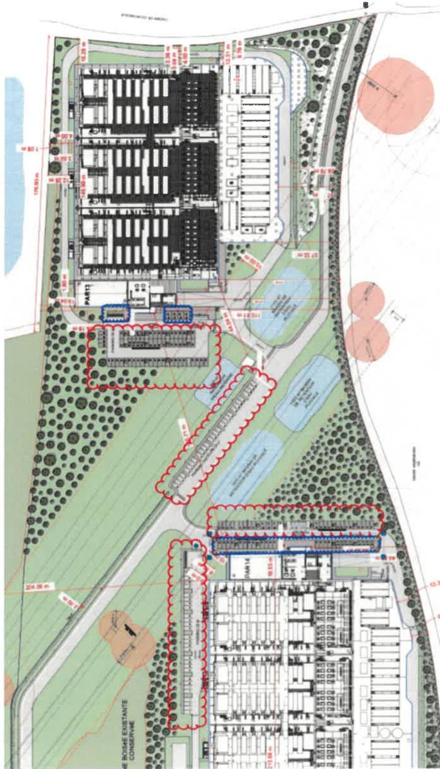
Extrait du plan de masse et stationnements perméables (rouge) / imperméables (bleu)
