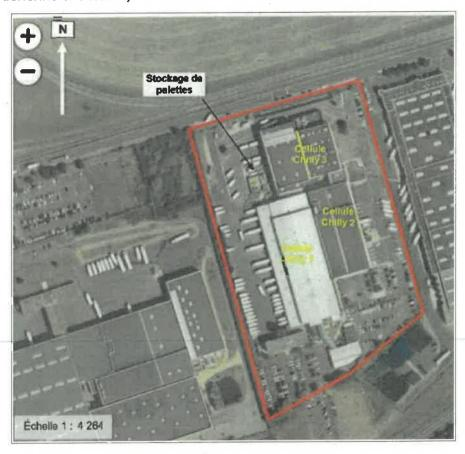
Le stockage extérieur de palettes bois est réalisé sur une dalle de stockage en béton d'une emprise totale de 15,6 m x 15,6 m, divisée en 2 parties :
