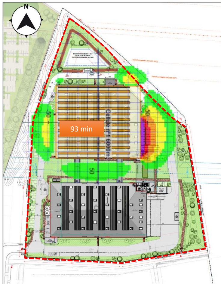
Figure 22 – Distances d'effets calculées par FLUMILOG – Cellule 1 - palette 2663
