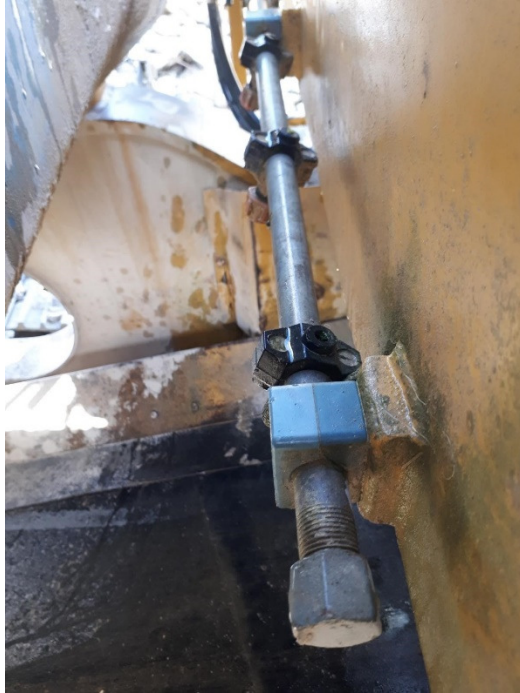
Rampe de pulvérisation.
