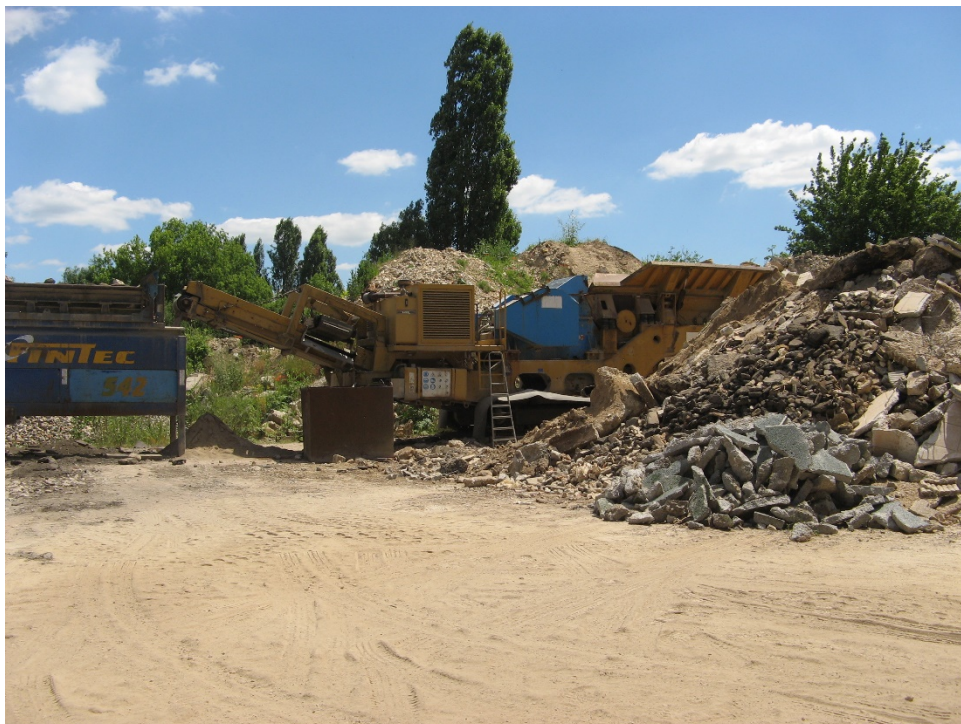
Installation mobile de concassage OM CRUSHER APOLLO.
