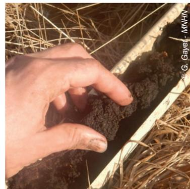
**b** Faites une boulette dans votre main en roulant le prélèvement **sans le compresser**. La boulette doit faire 4 cm de diamètre environ. Vous pouvez vérifier son diamètre sur les graduations de la gouttière.
