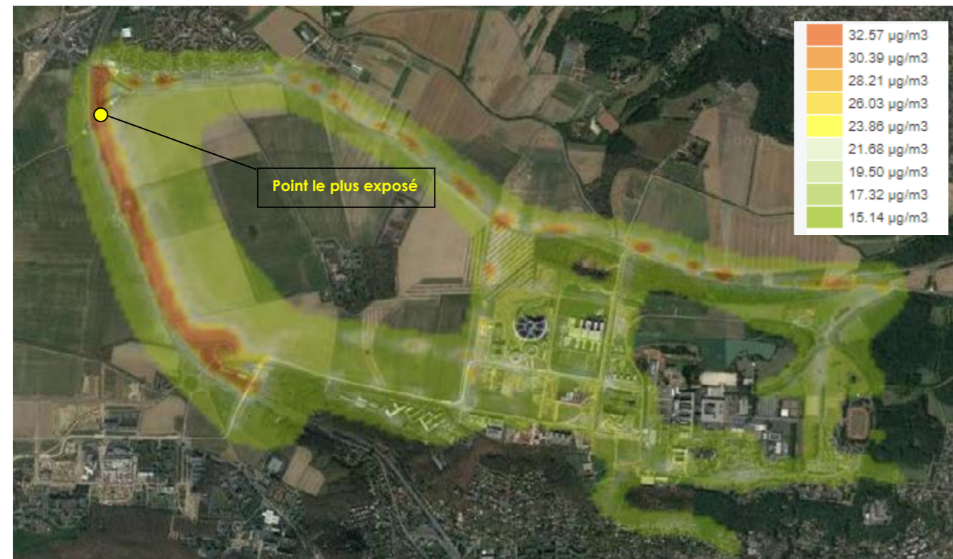
Concentrations au point plus exposé du secteur Est N118 (source CapAir, 2018)
