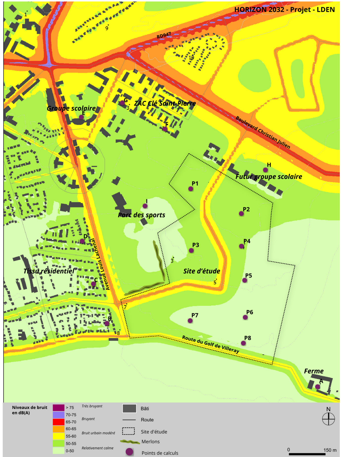
Niveaux sonores calculés à 4 m de hauteur - Horizon 2032 - Projet - LDEN (source TRANS-FAIRE, 2017)
