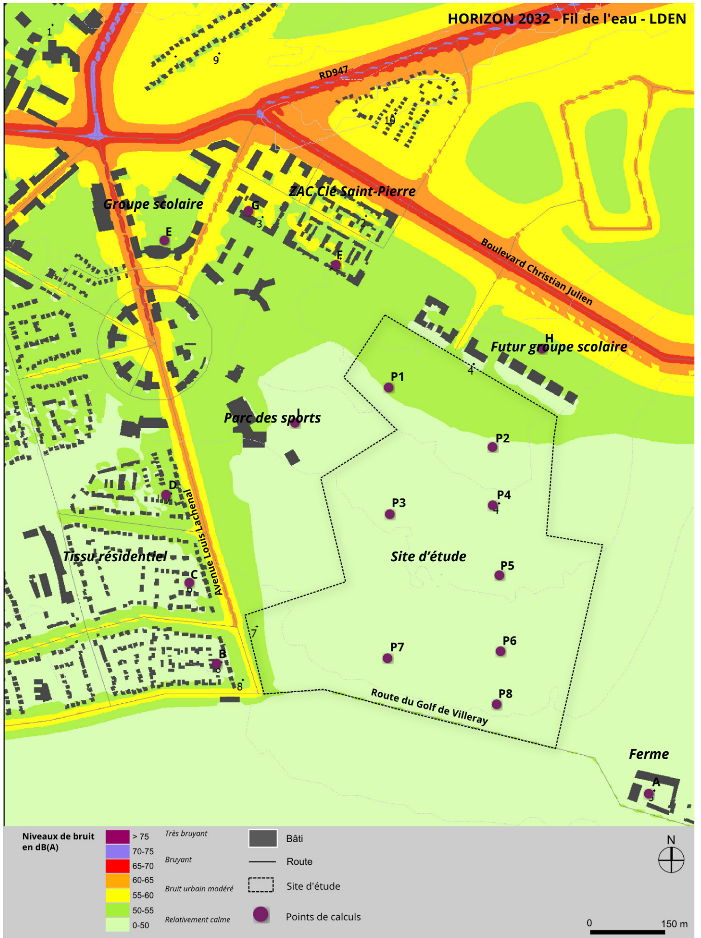
Niveaux sonores calculés à 4 m de hauteur - Horizon 2032 - Fil de l'eau - Lden (source TRANS-FAIRE, 2017)
