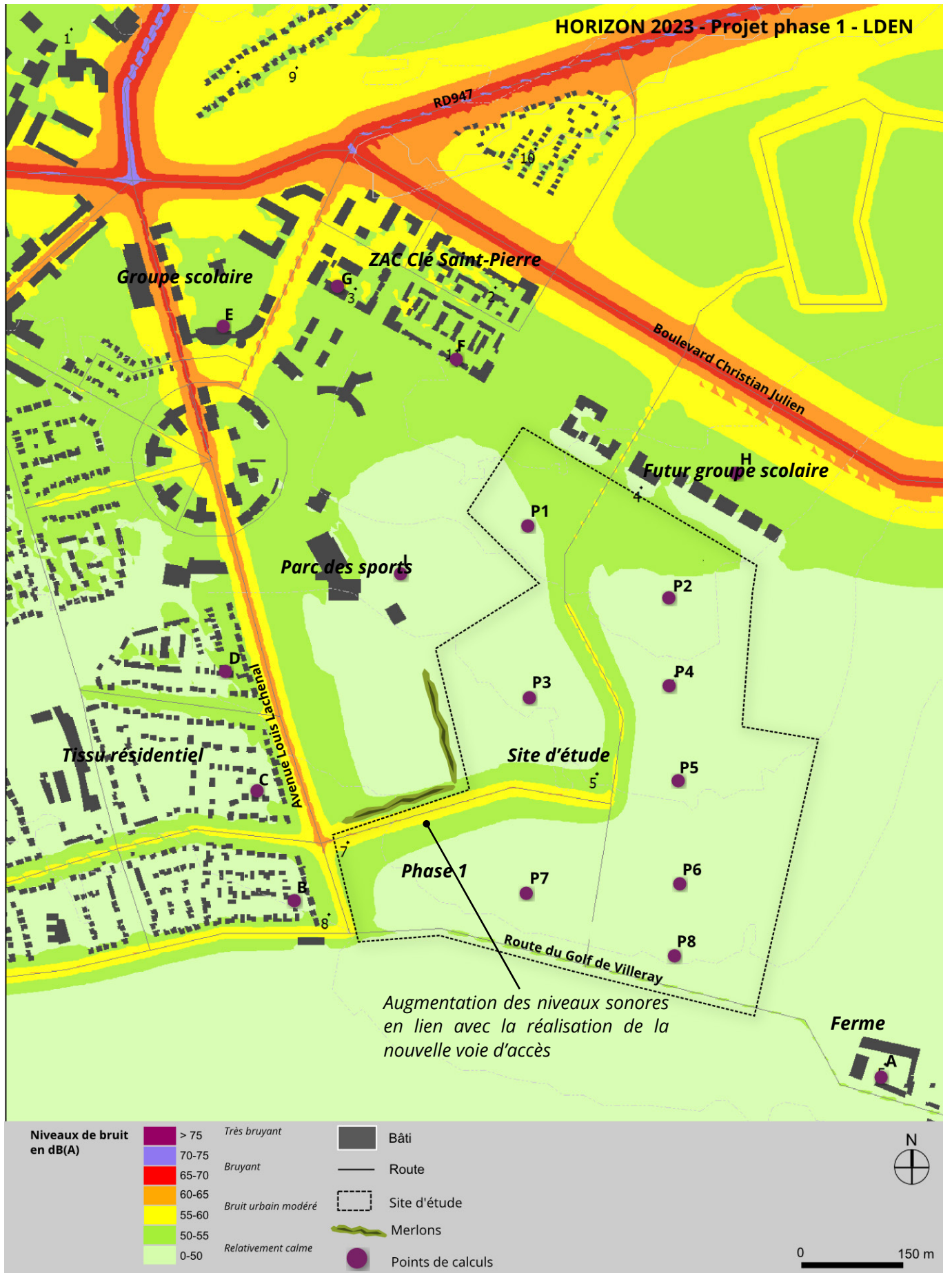
Niveaux sonores calculés à 4 m de hauteur - Horizon 2023 - Projet phase 1 - LDEN (source TRANS-FAIRE, 2017)
