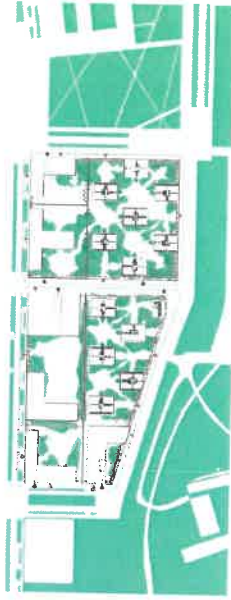
Figure 55. Principe d'un traitement unitaire des sols minéraux et des surfaces végétalisées à l'échelle des deux îlots.
