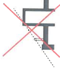
Figure 45. Édicules techniques en toiture invisibles depuis l'espace public
