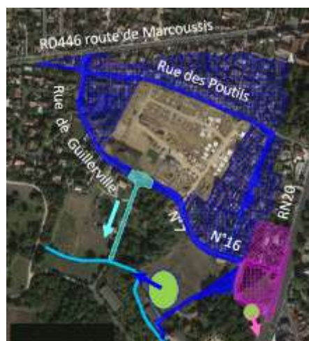
Organisation de l'assainissement eaux pluviales projetée (en vert, les deux bassins de rétention à créer)
