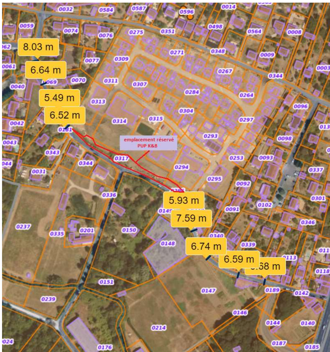
Emprise publique disponible sur quelques tronçons illustratifs de la rue de Guillerville
