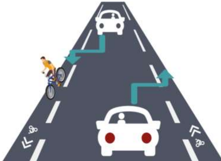
Principe d'une chaussée centrale à voie banalisée
