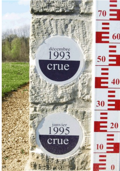
Repère et échelle limnimétrique
