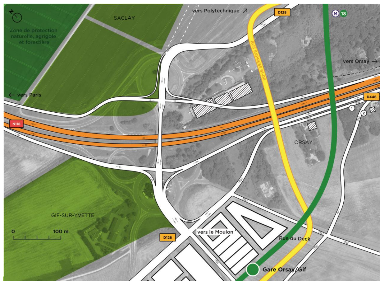
Figure 2. Configuration de l'échangeur de Corbeville envisagée dans le cadre du scénario n°1. (NB : deux solutions alternatives – ① ou ② – sont également montrées pour le rétablissement de la route de Versailles)
