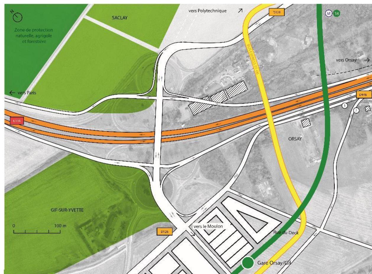
Figure 3. Configuration de l'échangeur de Corbeville envisagée dans le cadre du scénario n°2. (NB : deux solutions alternatives – ① ou ② – sont également montrées pour le rétablissement de la route de Versailles)
